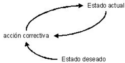
Ilustración 3: sistema de control
